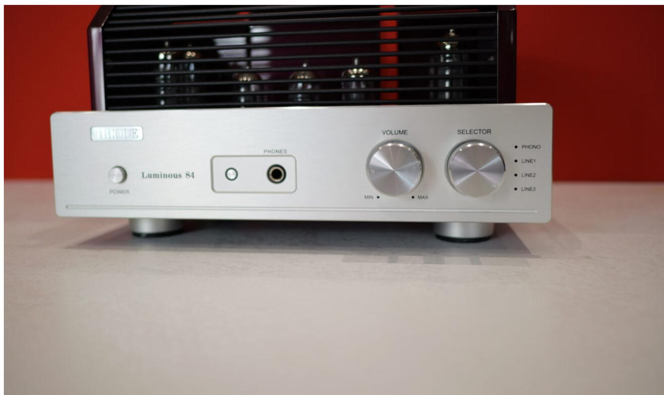
Un caro amico riparatore una volta ci disse che la forma fisica delle valvole nella maggior parte dei casi rispecchia il suo suono. Nel caso del Triode Luminous 84 parliamo di un amplificatore a valvole equipaggiato 4x EL84 modello 6BQ 5, 3x 12AU7 con una potenza nominale di 11 W su 8 ohm in classe A/B. In effetti il suono rispecchia un la conformazione delle EL84 un suono agile, con buon dettaglio e trasparenza.
