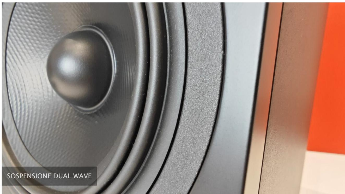
La grande novità però è la sospensione **Dual-Wave** che punta alla **diminuzione della distorsione**, compresa quella di intermodulazione, con lo scopo di offrire una
