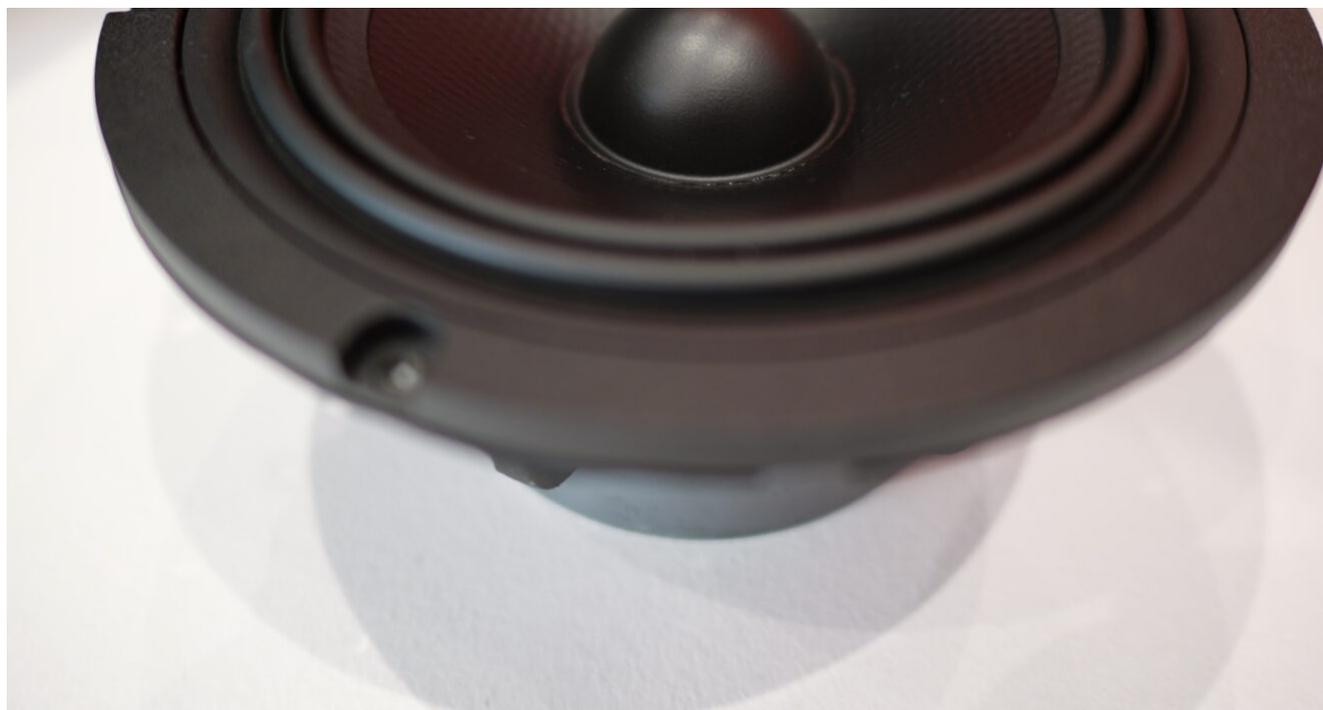
La membrana del driver è realizzata con questo particolare materiale chiamato CURV che altro non è che un **composito in polipropilene**. Il nucleo magnetico del trasduttore è altamente saturo, questo al fine di ridurre l'induttanza della bobina e migliorare la distorsione causata dalla variazione dell'induttanza. Sempre a proposito di induttanza viene utilizzato un anello di demodulizzazione chiamato **Aluring**.
